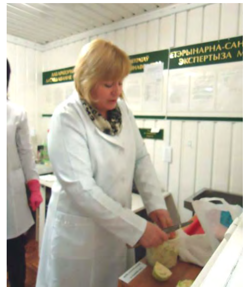
野菜等を細かく刻んで容器に入れて測定器（Naシンチレータ）にかけると10分程で結果が出る
