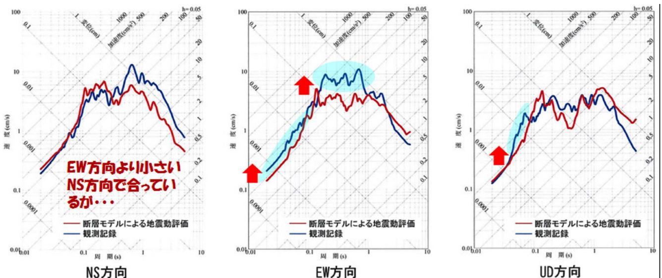
図1. 九州電力の特性化震源モデルによる1997年5月13日鹿児島県北西部地震の再現計算
