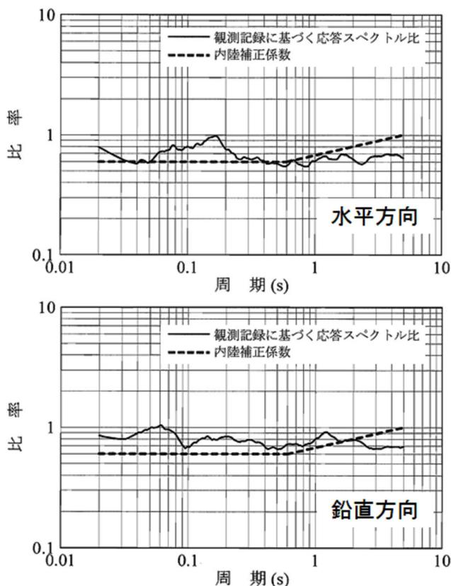
図2. 川内原発での内陸地殻内地震観測記録に基づく耐専スペクトルの補正係数
