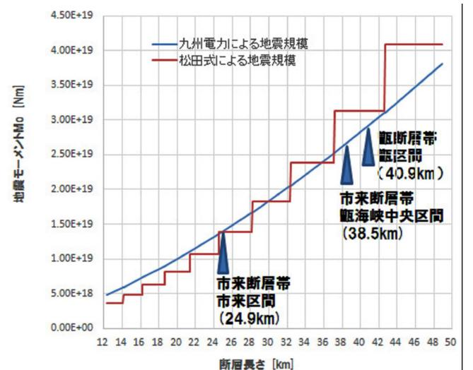
図3. 九州電力による地震規模と松田式による地震規模の比較(断層幅は13km)
