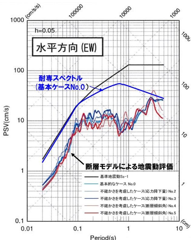
図4. 市来断層帯市来区間の耐専スペクトルと断層モデルによる地震動評価結果の比較
