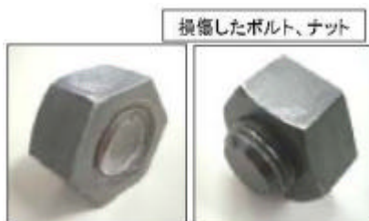
美浜1号炉充てんポンプの破断したボルト
