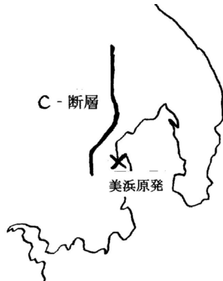
図5 美浜原発の直下にもぐり込んでいるC断層
