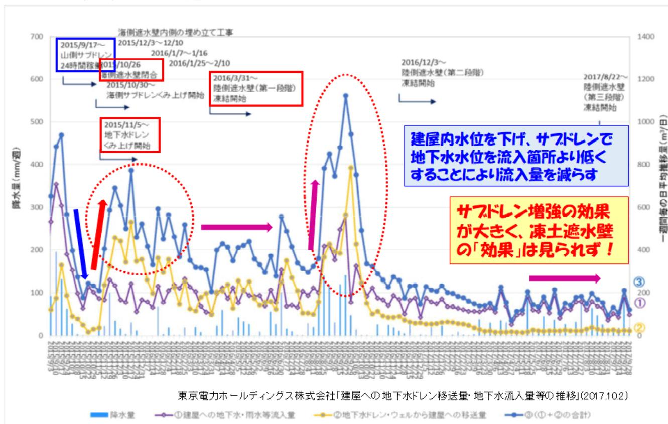
図1. 建屋への地下水ドレン移送量・地下水流入量等の推移(2015年9月～2017年9月)
