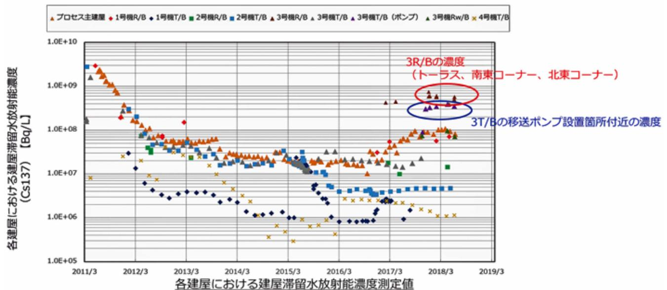
図3. 1～4号機建屋滞留水中の放射能濃度推移 (想定された当初の原因は、①高放射能濃度の1～3号復水器内貯留水移送、②建屋滞留水および等滞留水の影響、③建屋滞留水移送元にタービン建屋T/Bのみから原子炉建屋R/Bを追加(2015年10月～1号機R/Bから移送開始、2016年12月～2号機R/Bから移送開始)だが、復水器内貯留水の移送作業は限定的で一時的で、今回の上昇要因とは考えにくく、**○で囲った3号機原子炉建屋R/B汚染水**が図2のプロセス主建屋汚染水濃度急上昇の一因と推定されている)
