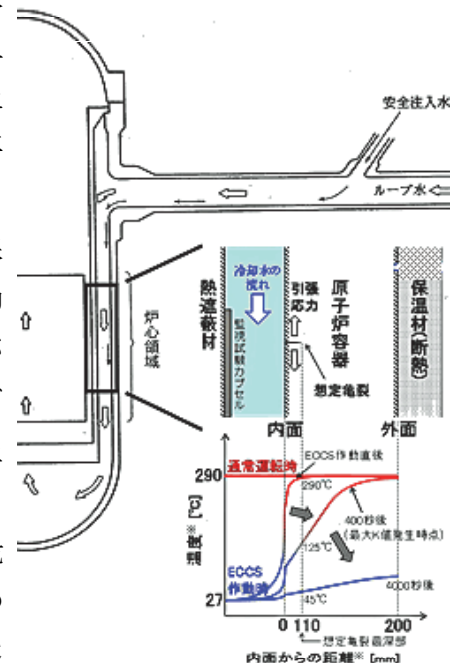
図5. 加圧熱衝撃のイメージ図
