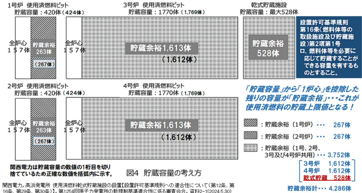
図1. 原子力規制委員会の新規規制基準適合性審査で関西電力が説明した乾式貯蔵と貯蔵容量の関係
