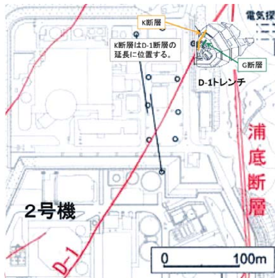
図1. 敦賀2号原子炉建屋直下を走るD-1破砕帯 およびD-1トレンチで発見されたK断層とG断層
